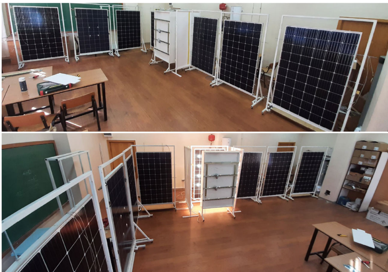
Figura 3. Sistem modular solar hibrid pentru încălzirea clădirilor cu producere simultană de energie electrică și apă caldă de consum
